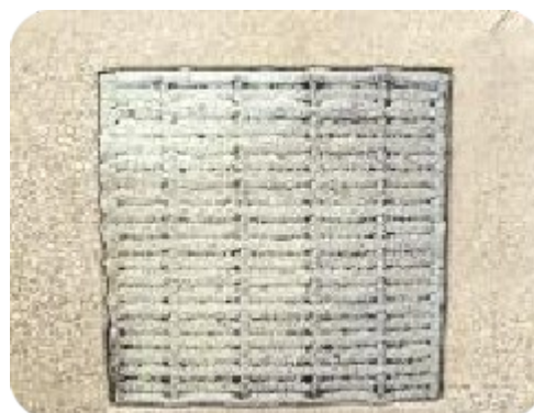
Rejilla RCF después de 90 minutos de ensayo de resistencia al fuego (cara no expuesta)
