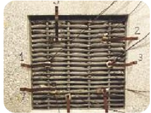
Rejilla RCF después de 60 minutos de ensayo de resistencia al fuego (cara no expuesta)
