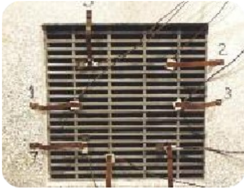
Rejilla RCF después de 30 minutos de ensayo de resistencia al fuego (cara no expuesta)
