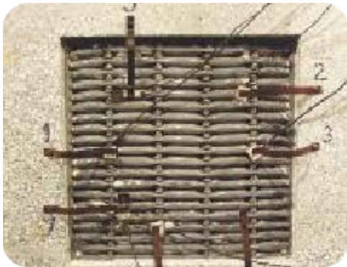
Rejilla RCF después de 90 minutos de ensayo de resistencia al fuego (cara no expuesta)
