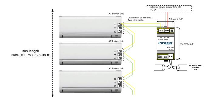
Figure 2.2 INMBSACA004I000 / INMBSACA008I000 /INMBSACA032I000 connection diagram
