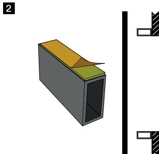
2. Desenganchar la cara adhesiva del E-TACO. Enganchar el E-TACO por detrás de la pared en las zonas donde irán los pestillos aproximadamente.
