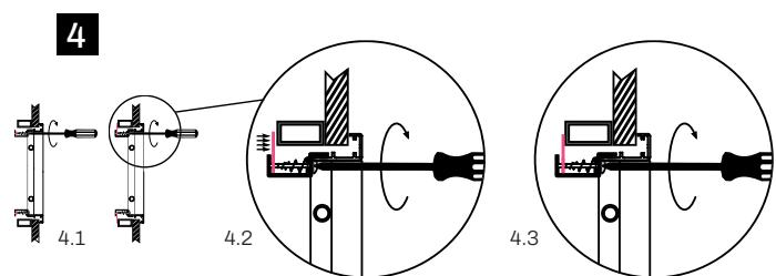
4.1 Girar tornillo mediante destornillador. El primer cuarto de vuelta la lengüeta del pestillo se coloca detrás del E-TACO
