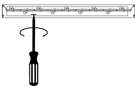
1. Girar corona mediante un destornillador hasta conseguir el grado de apertura deseado.
