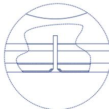
**Plenum:** El difusor se fija al plenum que a su vez está unido al techo, mediante un tornillo que enrosca en un puente situado en el interior del plenum.
